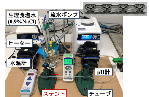
腐食試験の様子とステント形状
