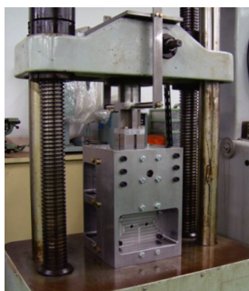
開発中のせん断変形加工機
